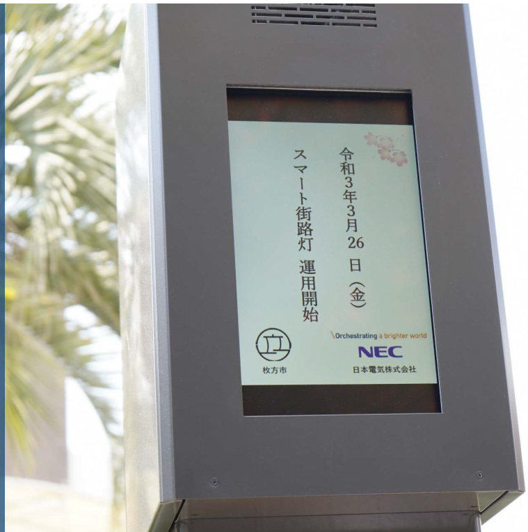
令和3年3月26日 NECとの連携により始まったスマート街路灯の運用。 デジタルサイネージによって情報発信するとともに、ふれあい通りの人の流れを計測しています。
