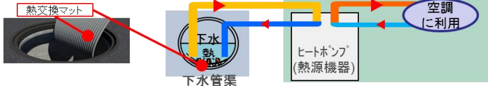
下水管(管径800mm)が埋設
